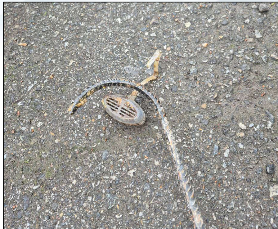
Блок от унитаза в общедомовой канализации, 2025 г.
